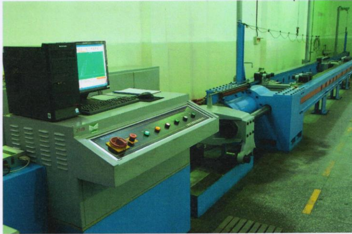
图 1-1 500kN 卧式拉力试验机 Fig.1-1 500kN hydraulic-electric horizontal tensile machine
